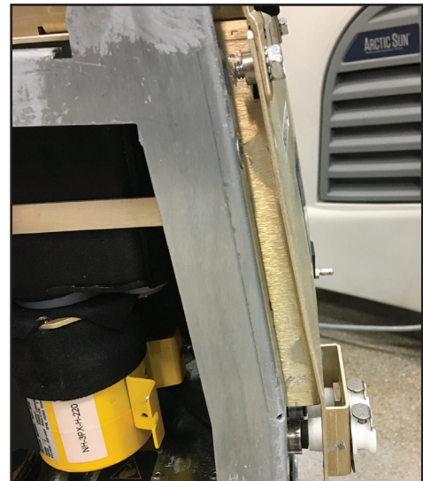
圖 8-37 外推的內部零組件 (步驟 4)
