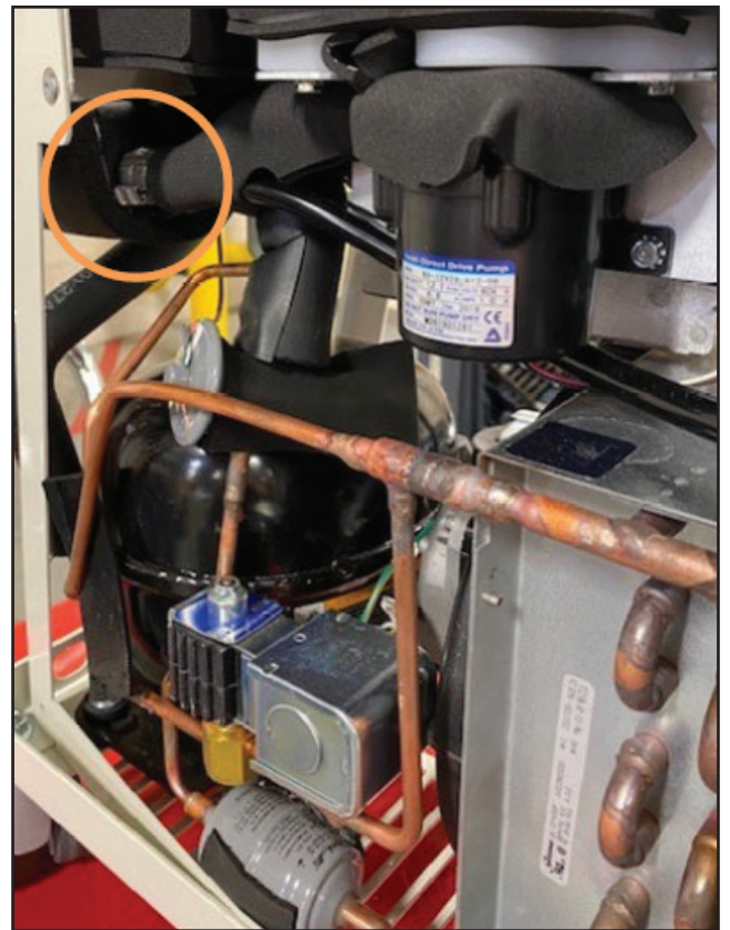
圖 8-22 移下兩個夾線箱 (步驟 3 — 直流幫浦)
