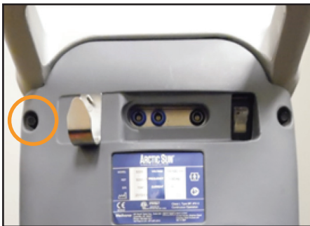
圖 8-72 拆除螺絲 (步驟 1)
