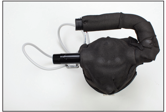
圖 8-53 流量計及標示水流方向的箭頭； 與循環幫浦出水同方向
