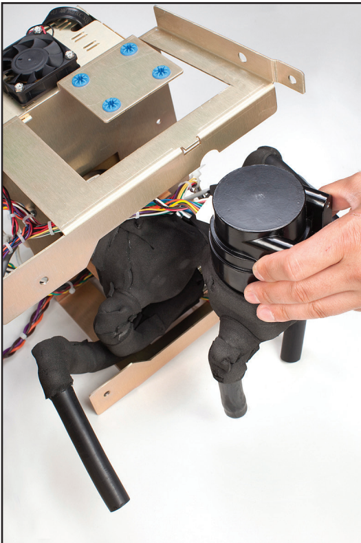
圖 8-31 小心取下混合幫浦 (步驟 5)
