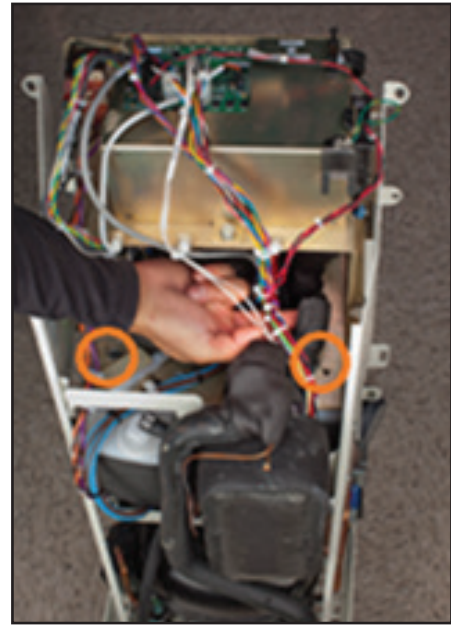
圖 8-17 拆除兩個螺栓 (步驟 2)
