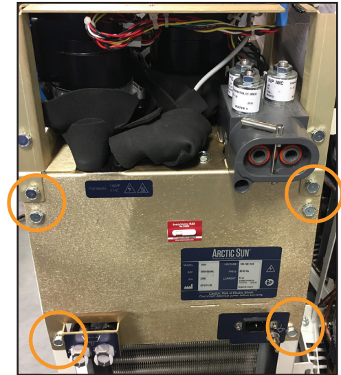
圖 8-36 拆除六個螺絲 (步驟 3)
