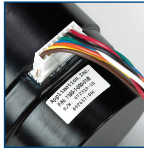
圖 8-32 連接前的幫浦接頭圖示 (上圖)；連接但一個接腳外露，安裝不正確 (左下圖)；及正確安裝 (右下圖)
